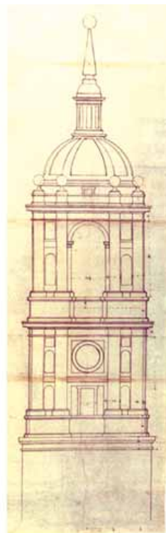
7.19. La escuela escorialense: (1) Juan Bautista de Toledo (h. 1567), Sección longitudinal de la Iglesia Mayor de El Escorial, a escala sin pitipié (535 × 402 mm); (2) Juan de Herrera (1579), Alzado de una de las torres de la Iglesia, traza «minimalista» con pequeñas transparencias (o vistas fantasmas) en las bolas externas (438 × 1397 mm). Dibujos a pluma, punzón y compás, en tinta sepia sobre papel verjurado (Biblioteca del Palacio Real de Madrid, Trazas 1/02 y 1/21, respectivamente; la Trazas 1/20 presenta la planta correspondiente de la torre)
