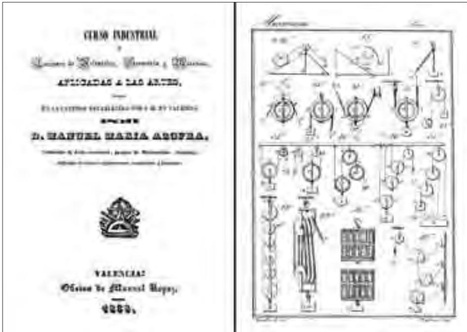
**11.2. Curso industrial de Manuel María de Azofra (1838):** En la lámina puede observarse el planteamiento estático de diferentes configuraciones de polipastos, con diagramas vectoriales de descomposición de fuerzas, aproximación clásica al estudio de las máquinas simples en los tratados de mecánica de comienzos de siglo.
