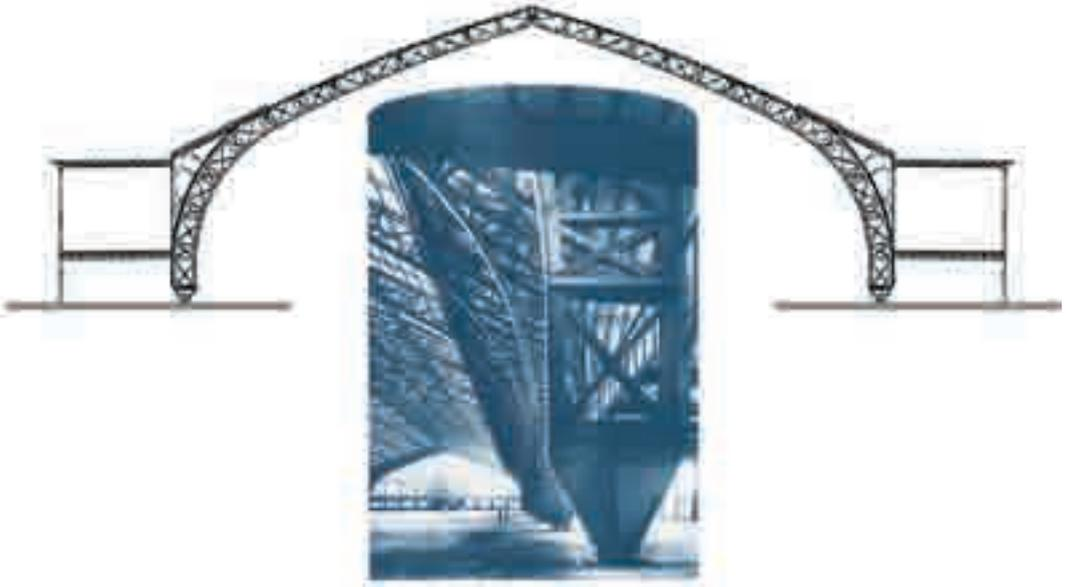
**9.7. Pórtico transversal triangulado de 112 m de luz:** *Corresponde a la Sala de Máquinas de la Exposición Universal de París de 1889.*
